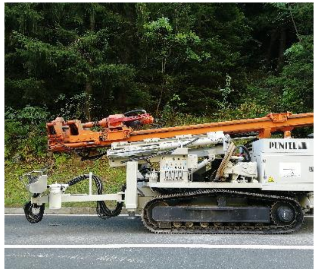
Sonda utilizzata per indagare l'imbocco di monte della galleria di derivazione (Lunghezza foro 200 metri)
