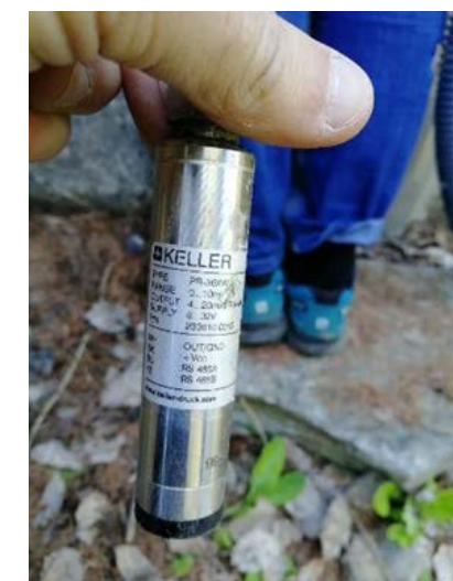
Sensore idrometrico installato all'interno del canale.
